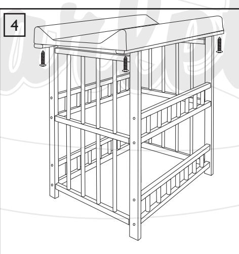
Ze spodní části nosných lišť připevníme vrtuty (4) přebalovací podložku
