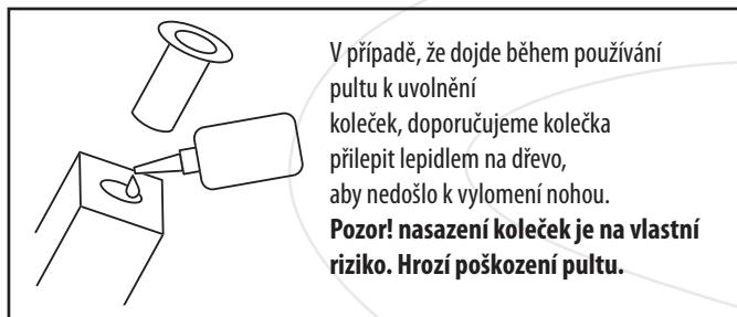
V případě, že dojde během používání pultu k uvolnění koleček, doporučujeme kolečka přilepit lepidlem na dřevo, aby nedošlo k vylomení nohou.
