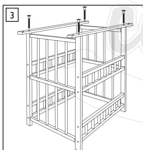
Pomocí velkých vrutů (7) připevníme nosné lišty k svislým sloupcům čel.
