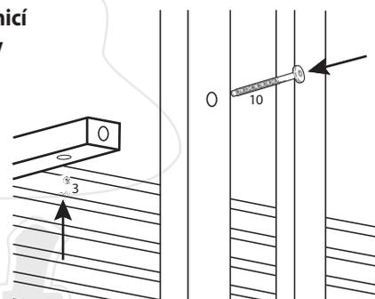
**3.** Šrouby (2) připevněte spodní držáky (4) ve spodní části nohou obou čelních stěn a do stahovacího boku (E) nasuntě skrz navrtané otvory kovové pruty (8), uprostřed s navléknutými středními držáky (5).
