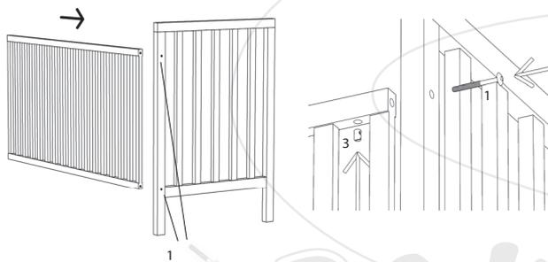
**2.** Šrouby (1) a válečkovými maticemi (3) připevněte rošt (D). Na výběr máte horní, nebo dolní polohu. **Válečkové matice (3) se při spojování s bočnicí postýlky vkládají vždy ze spoda roštu, nesmí dojít k otočení roštu, hrozí poškození roštu.**
