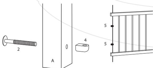
**4.** Vložte pruty (8) do spodních držáků (4) a šrouby (2) připevněte střední držáky (5) k čelům postýlky (A, C)
