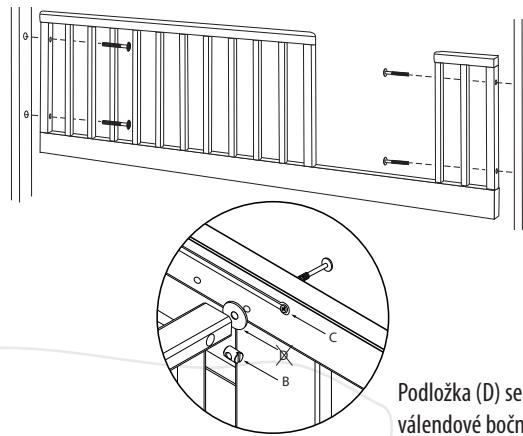
Podložka (D) se při montáži válendové bočnice nepoužívá.
