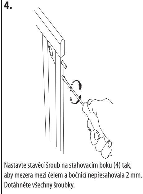
Nastavte stavěcí šroub na stahovacím boku (4) tak, aby mezera mezi čelem a bočnicí nepřesahovala 2 mm. Dotáhněte všechny šrouby.
