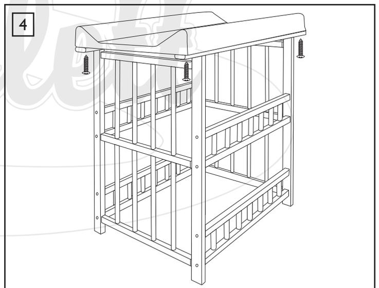
Vom unteren Teil der Tragschiene aus befestigen wir die Wickelaufflage mit Schrauben (4).
