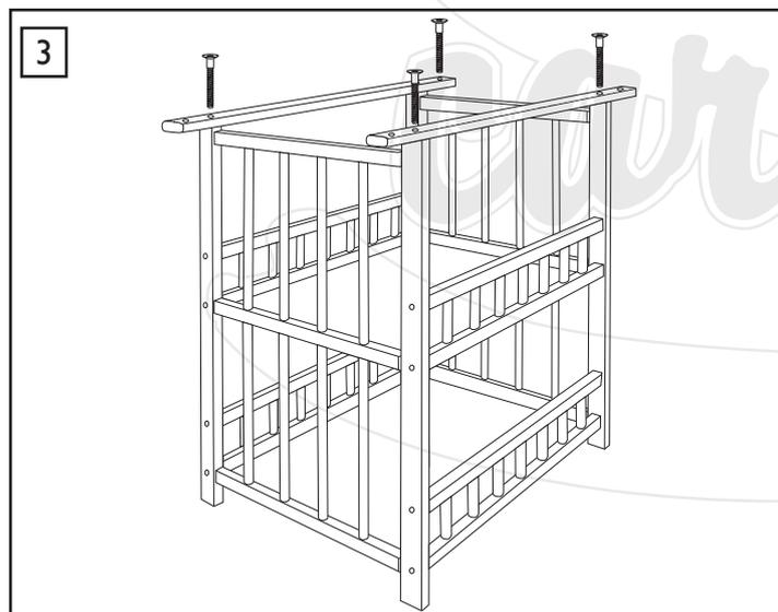
Mit großen Schrauben (7) befestigen wir die Tragschiene an den vertikalen Pfosten der Fronten
