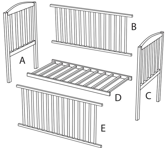
**1** Verbinden Sie mit Schrauben (1) und Zylindermuttern (3) die Vorderseiten (A, C) und die Seite des Kinderbetts (B).
