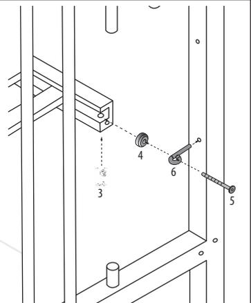
Die mittleren Querstreben an den Seitenwänden sind abnehmbar.
